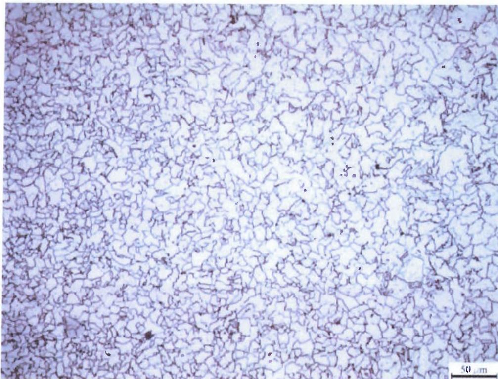
Figura 5.8 – Microestrutura da região central da ZAC com aumento de 200X.
