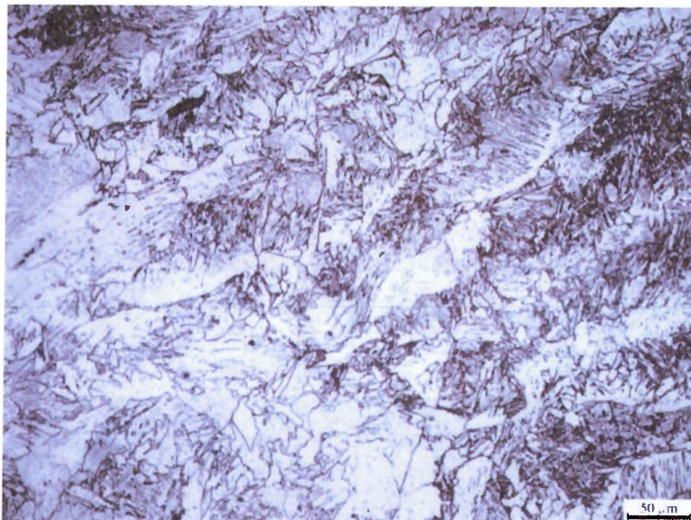
Figura 5.9 – Microestrutura da região de transição entre a ZAC a esquerda com grãos ferríticos bem grosseiros e o metal de solda a direita. Aumento de 200X.
