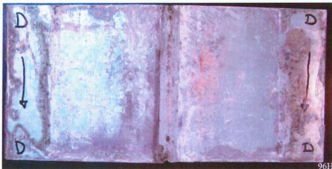
Figura 5.18 – Frente da matriz “D” com 96 horas de exposição no ensaio de névoa salina com aplicação de duas camadas de tinta rica em zinco (CRZ) e mais uma camada de tinta alumínio fosco. Apresentou início de corrosão branca.
