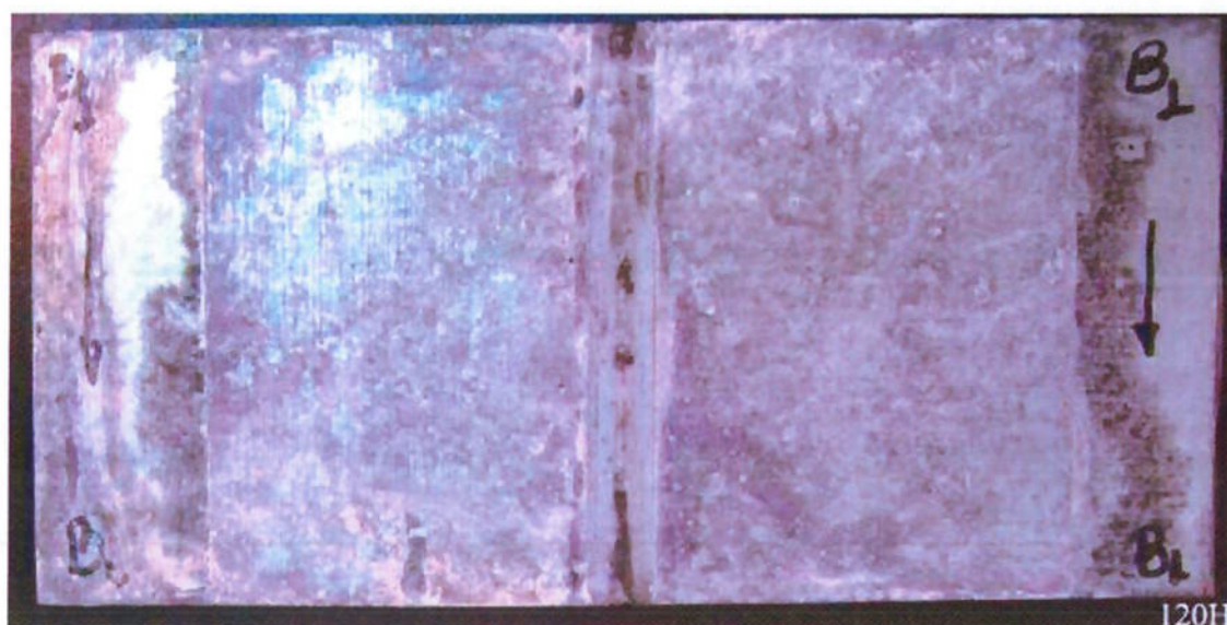
Figura 5.25 – Frente da matriz “B1” com 120 horas de exposição no ensaio de névoa salina com aplicação de duas camadas de tinta rica em zinco (CRZ) e com mais uma camadas de tinta alumínio fosca. Apresentou a continuação da corrosão branca.
