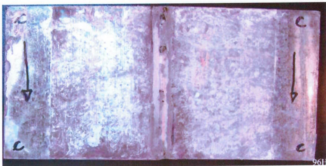
Figura 5.16 – Frente da matriz “C” com 96 horas de exposição no ensaio de névoa salina com aplicação de uma camada de tinta alumínio fosca verificado. Apresenta início de corrosão branca.
