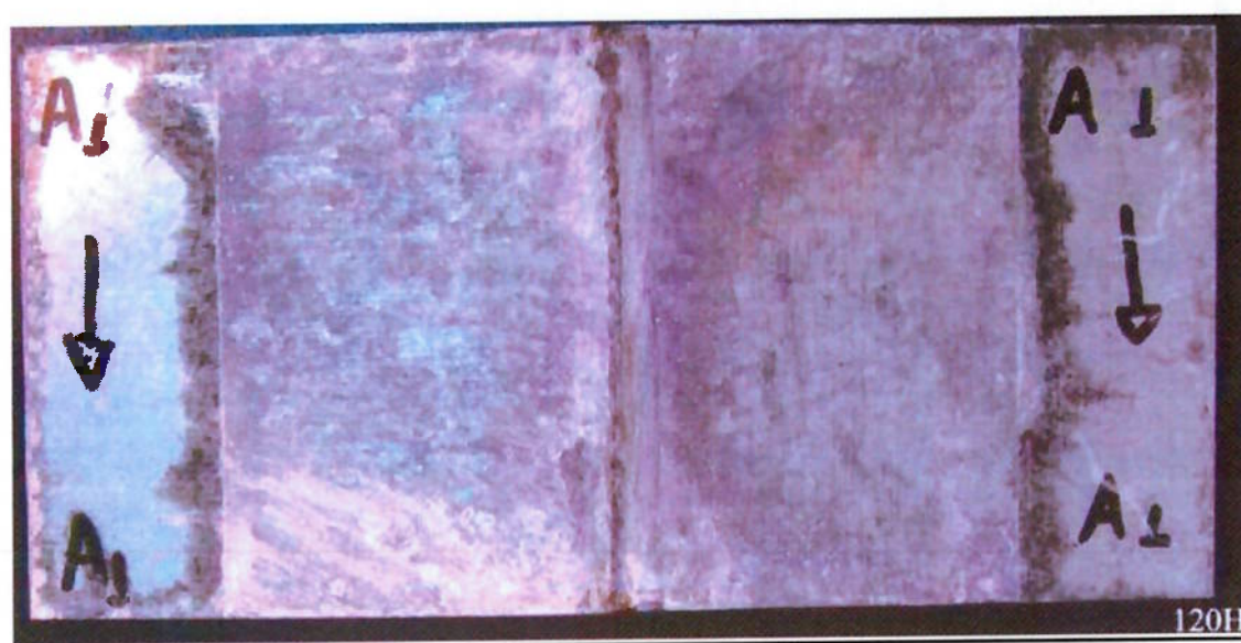
Figura 5.21 – Frente da matriz “A1” com 120 horas de exposição no ensaio de névoa salina sem aplicação de proteção. Apresentou maiores pontos de corrosão vermelha.
