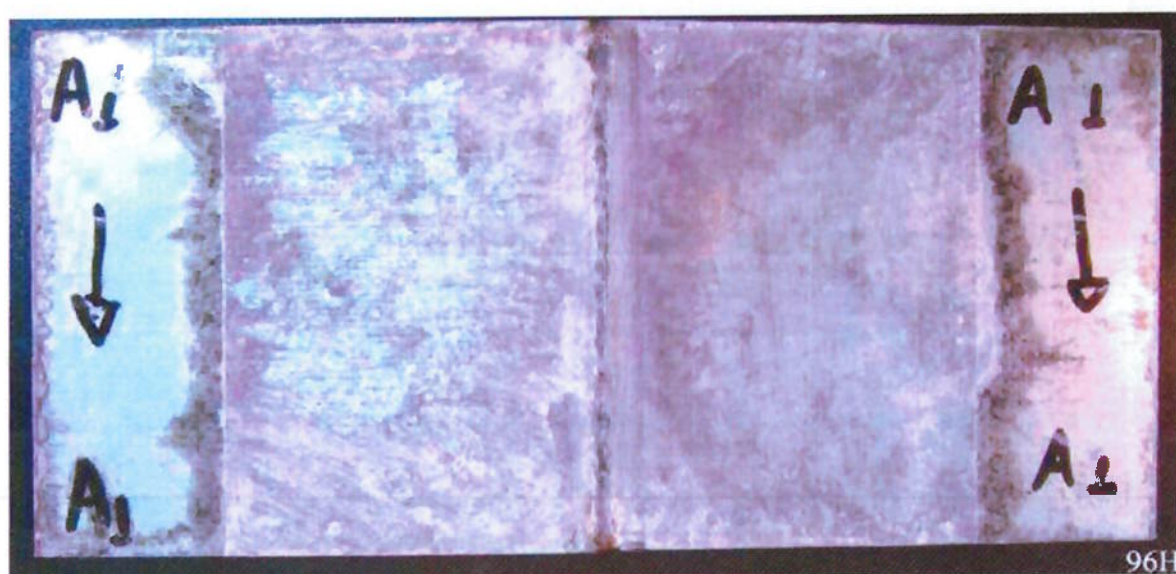
Figura 5.13 – Frente da matriz “A1” com 96 horas de exposição no ensaio de névoa salina sem aplicação de proteção extra. Apresenta início de pequenos pontos de corrosão vermelha.
