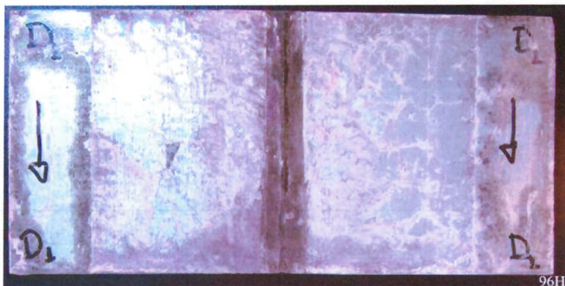
Figura 5.19 – Frente da matriz “D1” com 96 horas de exposição no ensaio de névoas salina com aplicação de duas camadas de tinta rica em zinco (CRZ). Apresentou início de corrosão branca.
