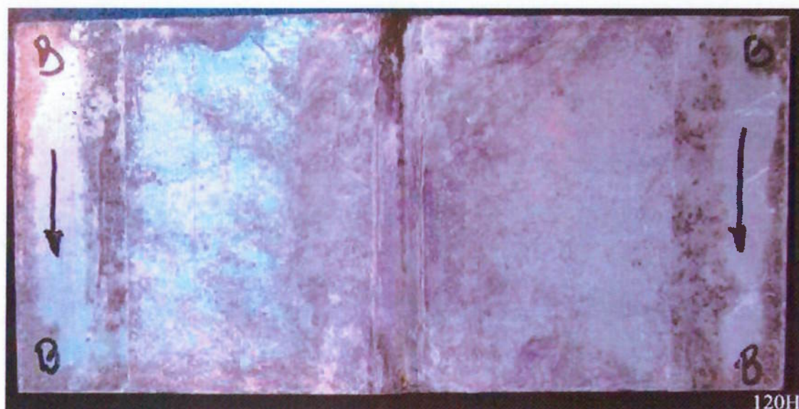
Figura 5.24 – Frente da matriz “B” com 120 horas de exposição no ensaio de névoa salina com aplicação de duas camadas de tinta rica em zinco (CRZ). Apresentou a continuação da corrosão branca.
