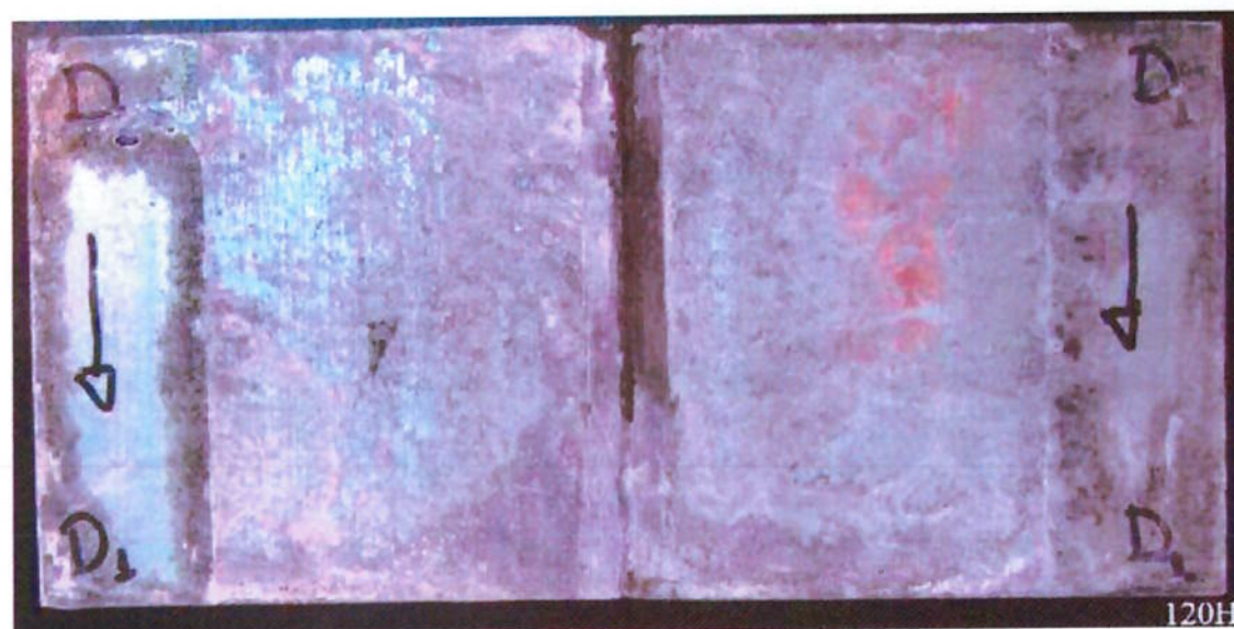
Figura 5.27 – Frente da matriz “D1” com 120 horas de exposição no ensaio de névoa salina com aplicação de duas camadas de tinta rica em zinco (CRZ). Apresentou a continuação da corrosão branca.
