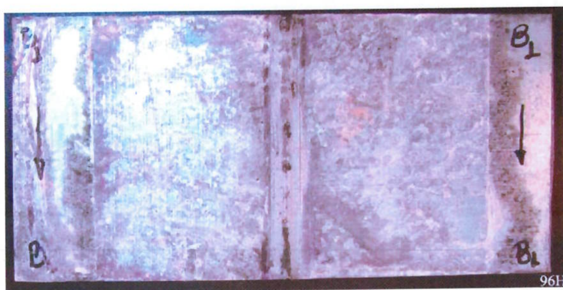
Figura 5.15 – Frente da matriz “B1” com 96 horas de exposição no ensaio de névoa salina com aplicação de duas camadas de tinta rica em zinco (CRZ) e aplicação de mais uma camada de tinta de alumínio fosca. Apresenta início de corrosão branca.
