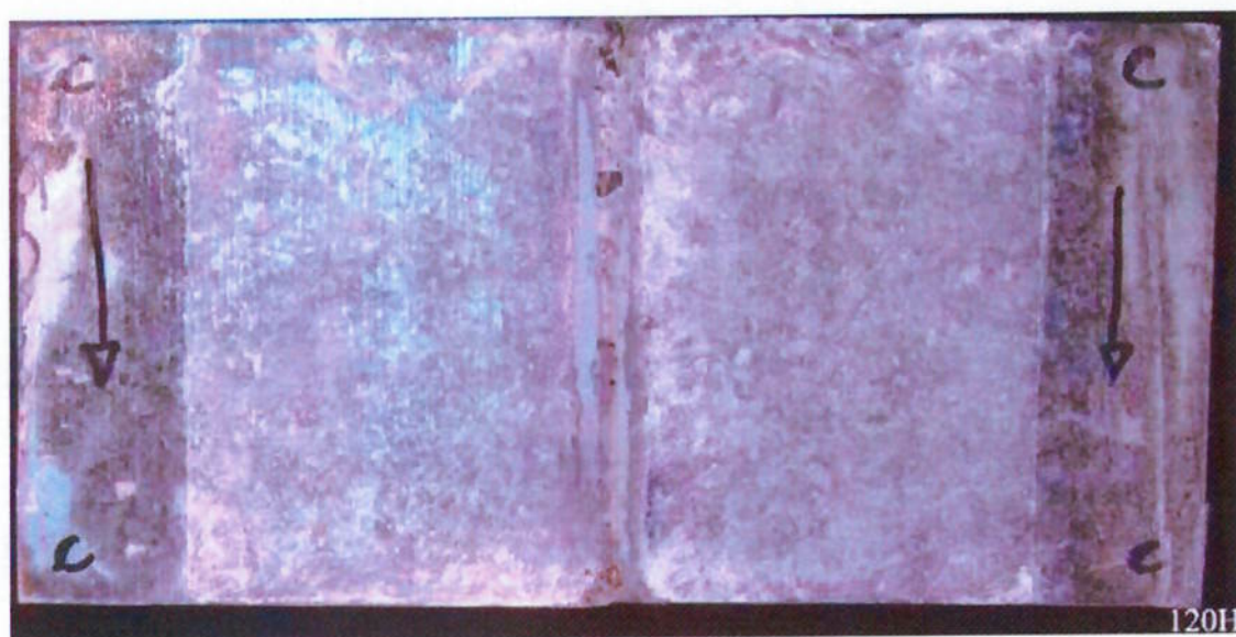
Figura 5.22 – Frente da matriz “C” com 120 horas de exposição no ensaio de névoa salina com aplicação de uma camada de tinta alumínio fosca. Apresentou início de pequenos pontos de corrosão vermelha.
