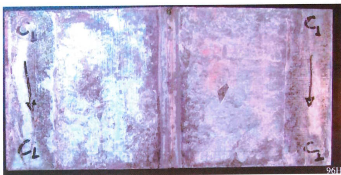
Figura 5.17 – Frente da matriz “C1” com 96 horas de exposição no ensaio de névoa salina com aplicação de uma camada de tinta alumínio fosca verificado. Apresenta início de corrosão branca.
