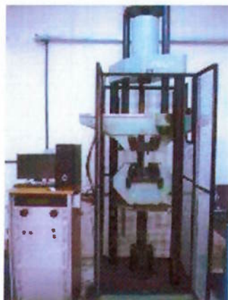
Figura 4.5 – Equipamento de tração Marca Wolpert®, Modelo n/c, tipo eletro-hidráulica nº 1263, capacidade de carga máxima de 60.000 Kgf.
